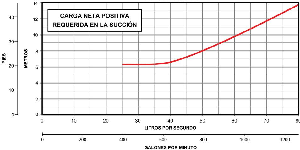
● Para mantener la mejor eficiencia en modelos con pasos recortados se limita el rango de flujo a los mostrados en las curvas.
