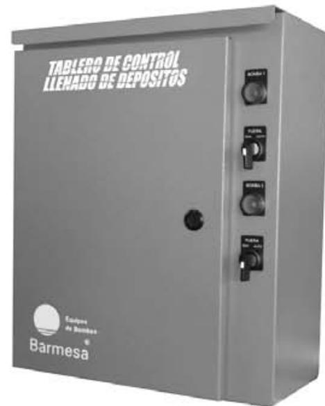
Los tableros de control para llenado de depósitos se utilizan en Sistemas donde se requiere mantener un nivel de agua en una o varias cisternas o depósitos, este tablero trabaja en conjunto con las bombas, y peras de nivel ,las cuales se colocan dentro del depósito de manera escalonada.para garantizar un buen nivel del liquido.
