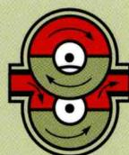
**3** El impulsor superior transfiere líquido de la succión a la descarga. El impulsor inferior inicia el ciclo de succión y finaliza el ciclo de descarga.
