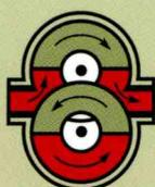
**1** El impulsor superior ha iniciado el ciclo de succión y se completa el ciclo de descarga. El impulsor inferior transfiere líquido de la succión a la descarga de la bomba.
