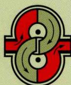
**2** Se completa el ciclo de succión por el impulsor superior. Se inicia el ciclo de descarga del impulsor inferior.
