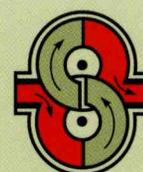
**4** El impulsor superior inicia el ciclo de descarga. El impulsor inferior finaliza el ciclo de succión.
