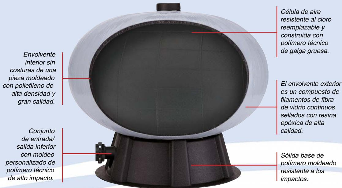
Envolvente interior sin costuras de una pieza moldeado con polietileno de alta densidad y gran calidad.
